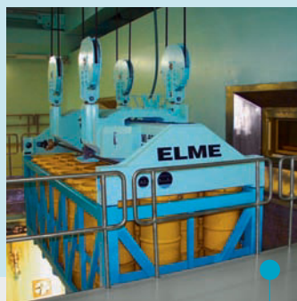
LAGERCONTAINER FÜR SCHWACH- UND MITTELAKTIVE ABFÄLLE
